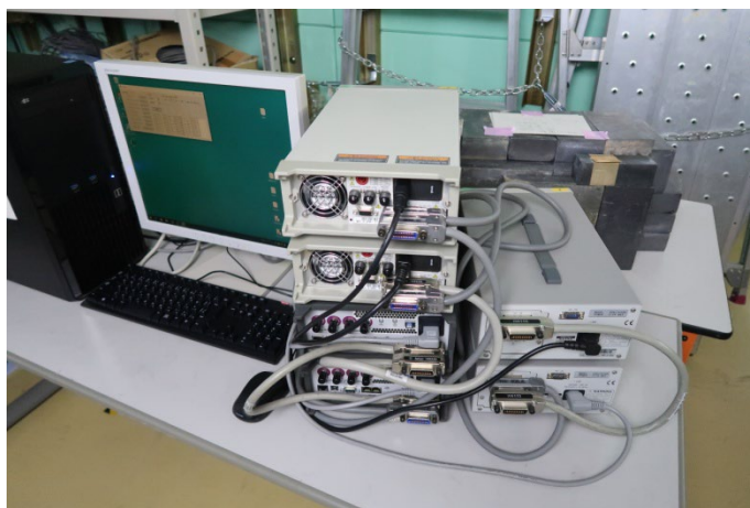
図1：開発例（光センサーのI-V特性とC-V特性を調べるテストベンチの開発研究）
